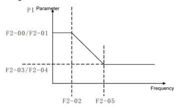
Figure 5 - 03 pi parameter diagram
