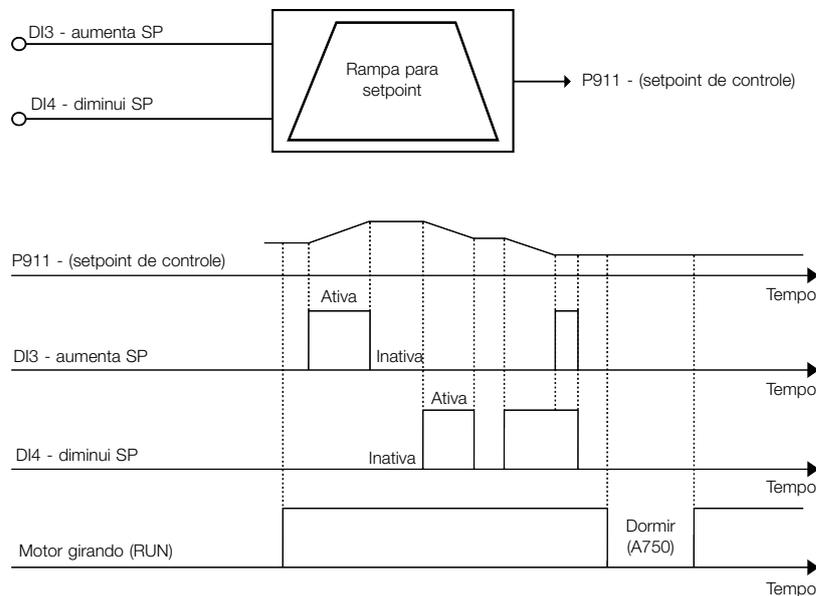
**Figura 14.3:** Gráfico de funcionamento da função E.P.
