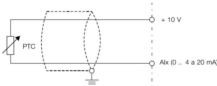
*Figura 10.1: Conexão do PTC ao inversor de frequência*
