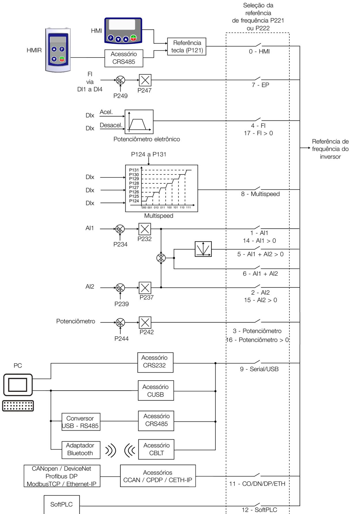
**Figura 7.2:** Estrutura de seleção da referência de frequência
