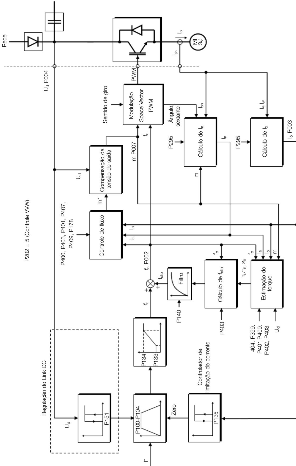
Figura 8.20: Esquema de controle VVW
