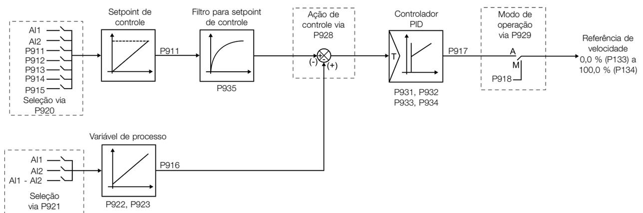
Figura 14.1: Blocodiagrama do controlador PID
