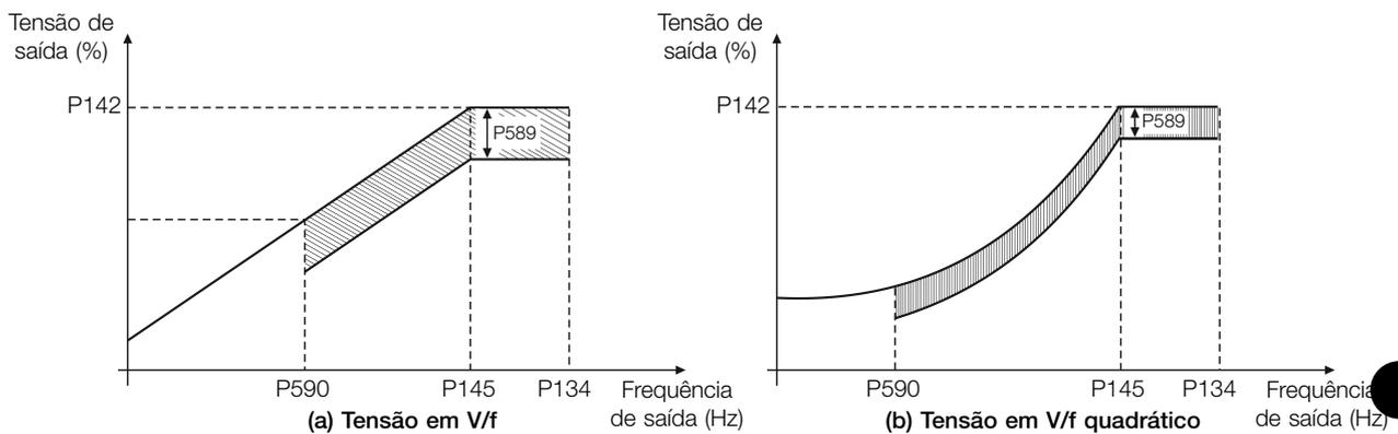
Figura 8.19: (a) e (b) Exemplo de comportamento da tensão em V/f e V/f quadrático
