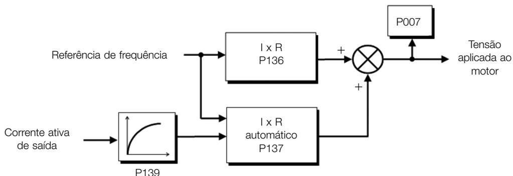
**Figura 8.17:** Blocodiagrama do boost de torque automático
